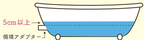
※凍結防止運転で、ポンプが自動的に浴槽の水を循環させて凍結を予防します。
